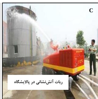
شکل ۷-۲۱ برخی از فناوری‌های جدید کنترل حریق: (A) توپک‌های خاموش‌کننده در پمپ بنزین، (B و C) ربات‌های آتش‌نشان.
