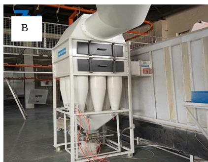
شکل ۱-۵ تصاویر سیکلون: (A) سیکلون منفرد، (B) سیکلون به شکل سری یا موازی، (C) نمایی از مسیر ورود و خروج گاز همراه ذرات.
