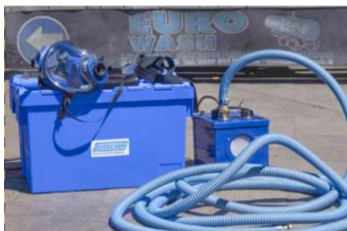
شکل ۴-۶ سیستم تنفسی فرار اضطراری (سمت راست) و نمونه ای از هوارسان دائم (سمت چپ).
